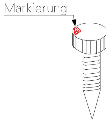
2. neue Schraube OHNE Feder eindrehen und die Umdrehungen zählen, die Farbmarkierung erleichtert das sehr. Ein Tropfen WD 40 ans Gewinde. Schraube wieder herausdrehen.
