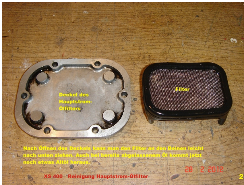
Abbildung 7: Deckel und Hauptstromölfilter
