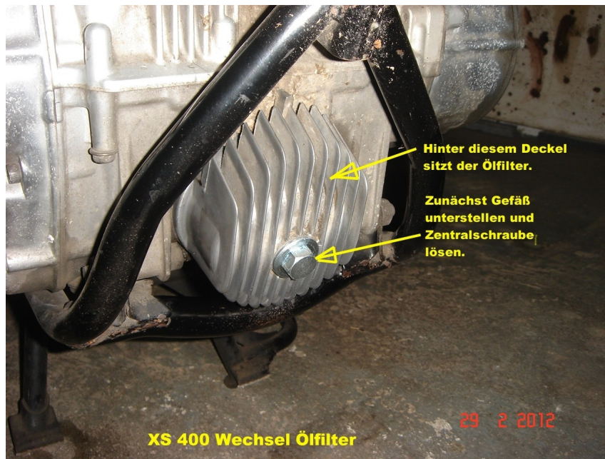
Abbildung 1: Motor mit Ölfiltergehäuse
