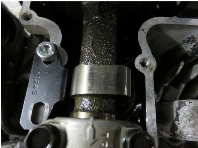
*Abbildung 5 Ventileinstellwerkzeug im Einsatz am rechten Einlassventil (Hier mit guter Position des Nockens für die Entnahme des Shim!)*
