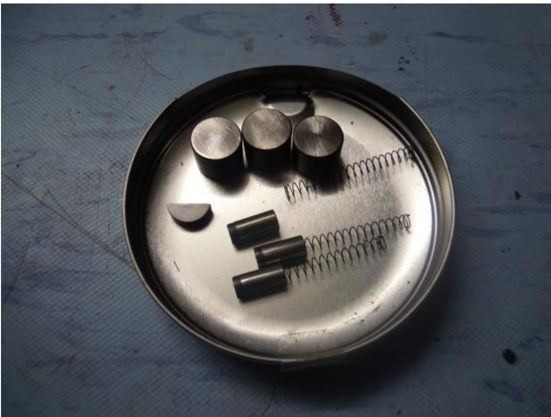
Abbildung 12: Kleinteile – je 3 Mitnehmerzylinder, Federn, Hülsen und der Halbmond von der Kurbelwelle
