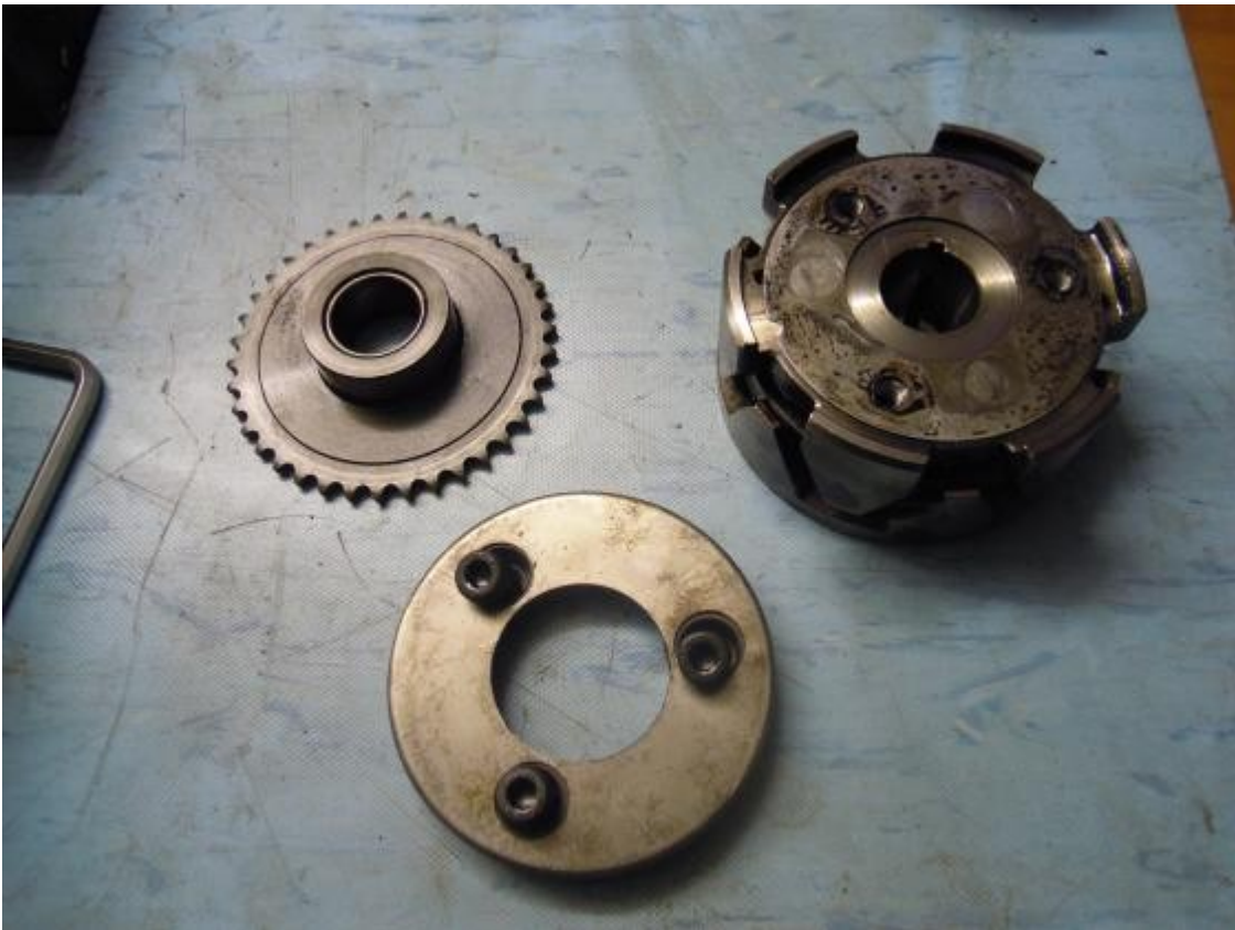
Abbildung 11: Klauenpolrotor (rechts) und Anlasserfreilauf auf der Werkbank
