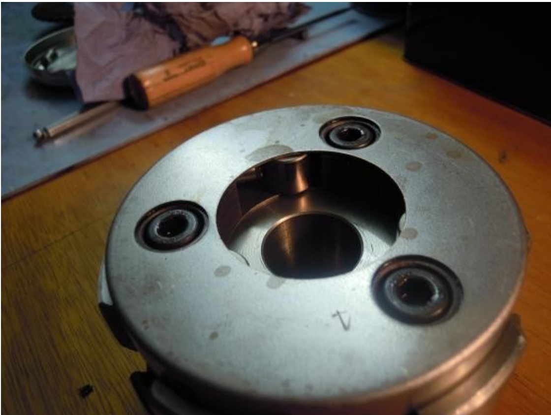
Abbildung 13: Zusammenbau des Anlasserfreilaufs
