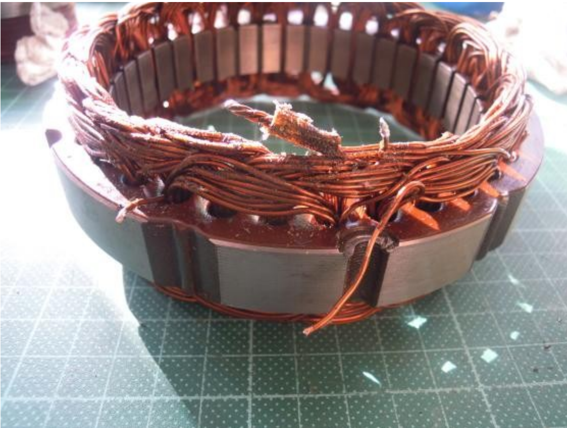
Abbildung 4: Anschlüsse am Stator nach Entfernen der Isolierung und der Kabelenden
