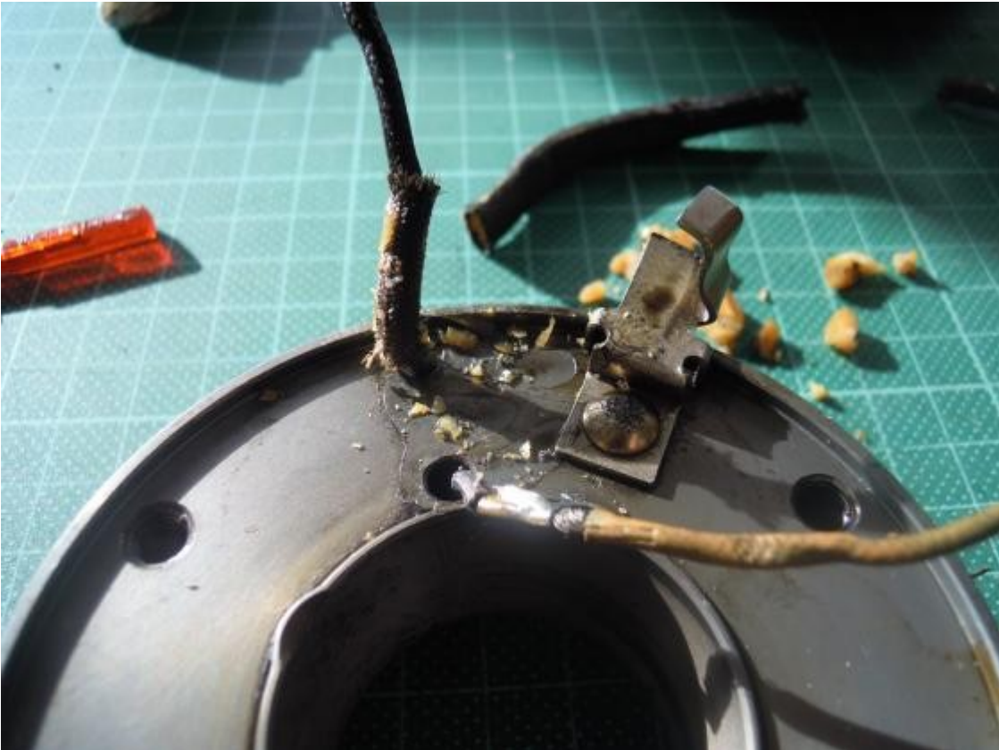
Abbildung 2: Kabelanschlüsse an der Erregerspule nach Ablösen der Isolierung (Reste des Isolierklebers sind im Hintergrund zu erkennen)
