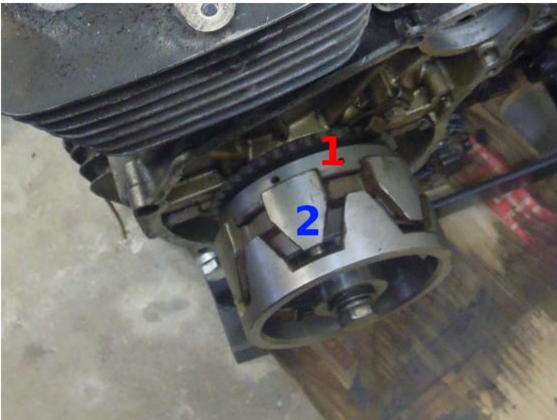
Abbildung 9: Klauenpolrotor (2) und Anlasserfreilauf (1) auf dem linken Kurbelwellenstumpf
