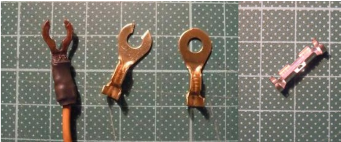
Abbildung 7: selbstgemachter Kabelschuh (2. von links), links das Original; ganz rechts ein Stoßverbinder zum Anklemmen der Kabel an die Drähte der Spulen
