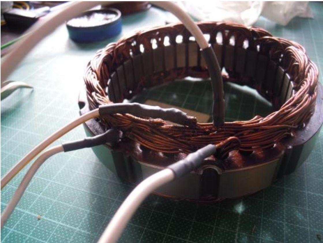
Abbildung 5: Stator mit neuen Kabeln
