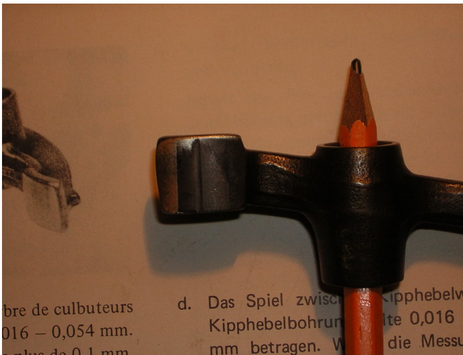
Abbildung 7: Kipphebel an der Nockenwelle eingelaufen
