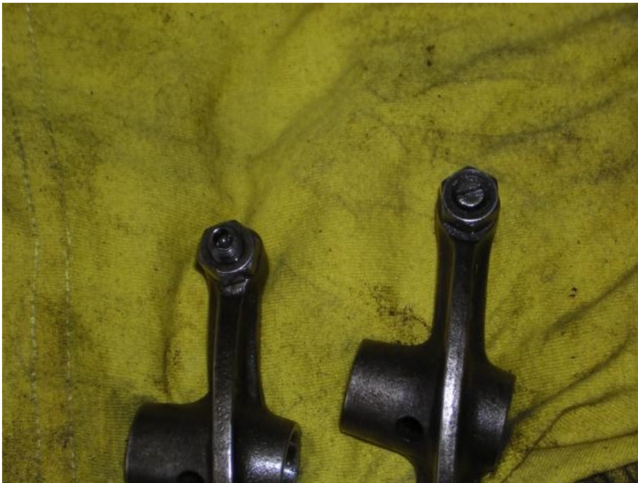
Abbildung 4: Kipphebel mit verschiedenen Einstellschrauben (Inbus- oder Schlitzschraube)
