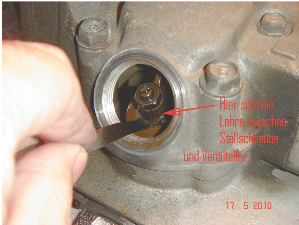
Abbildung 6: so fühlt man das Ventilspiel
