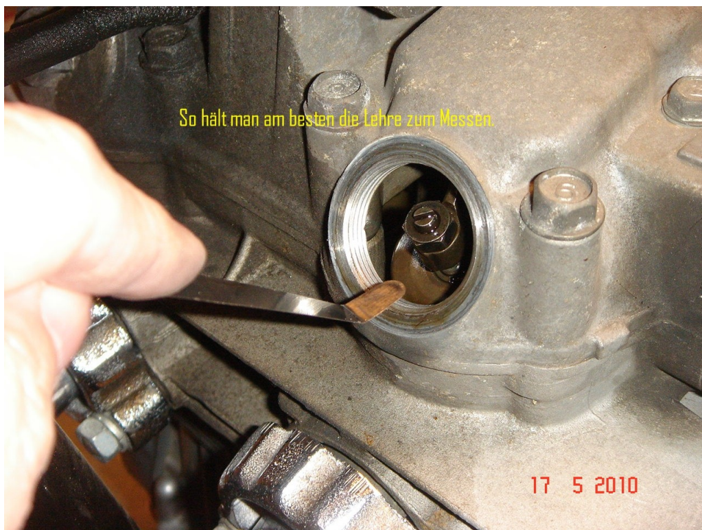
Abbildung 5: die Fühlerlehre wird angesetzt
